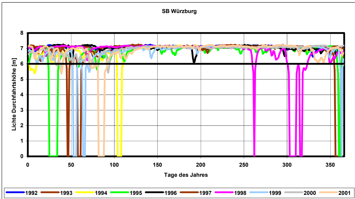
Abb. 9: Verlauf der lichten Durchfahrtshöhen der Alten Mainbrücke Würzburg
